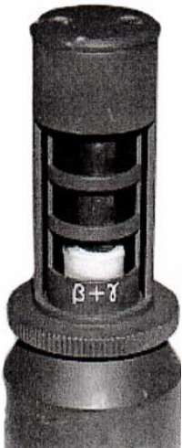
Figura 14 – Diaframma aperto, misure Beta + Gamma
